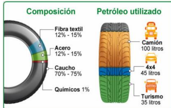
Ilustración 2. Composición de los neumáticos
